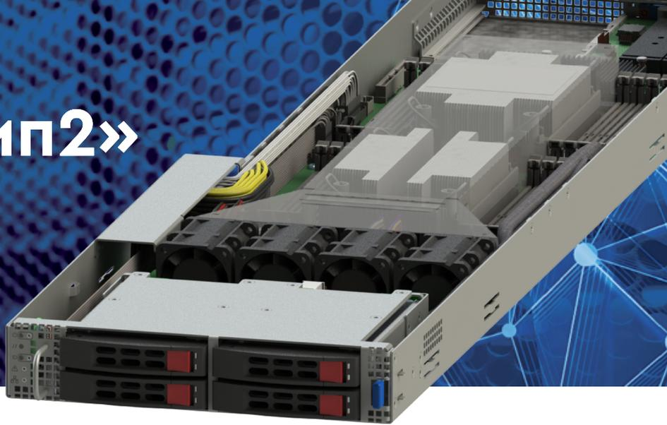
Модуль вычислительный «Тип2» – двухпроцессорный 1U вычислительный модуль с поддержкой горячей замены (без остановки работы шасси в целом и других модулей), предназначенный для работы в составе шасси Паладин-МШУ G2.
