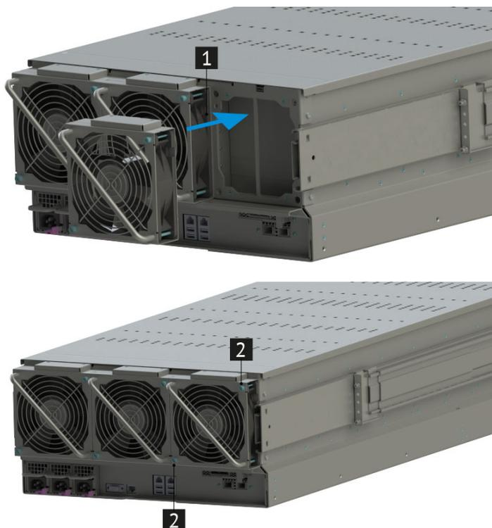
**Рис. 29. Подключение наружного вентилятора к корпусу сервера**
