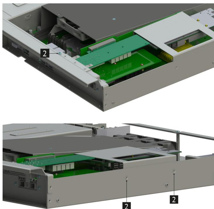
Рис. 47. Установка адаптера поворотного НИКА.469535.122 с картами расширения
