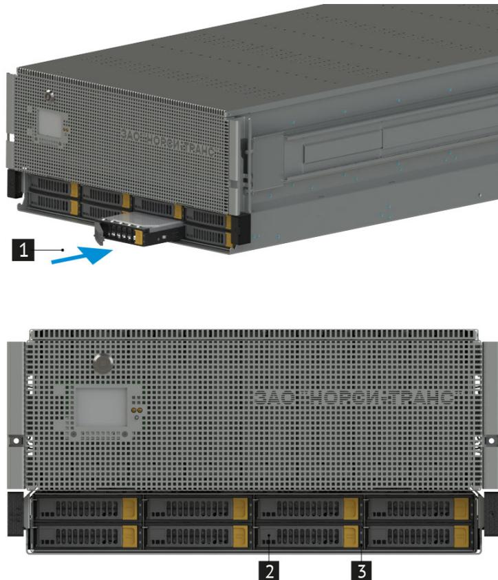
Рис. 43. Установка дисков
