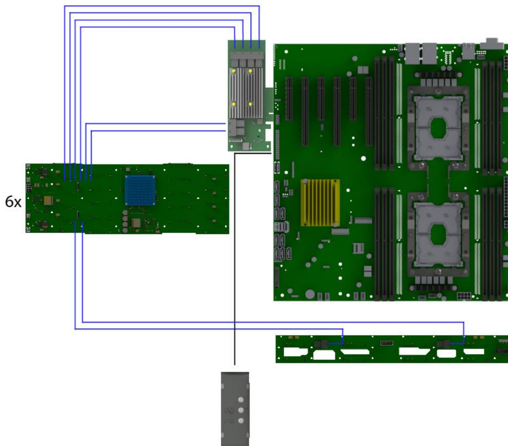
Рис. 25. Схема прокладки системных кабелей и кабелей питания
