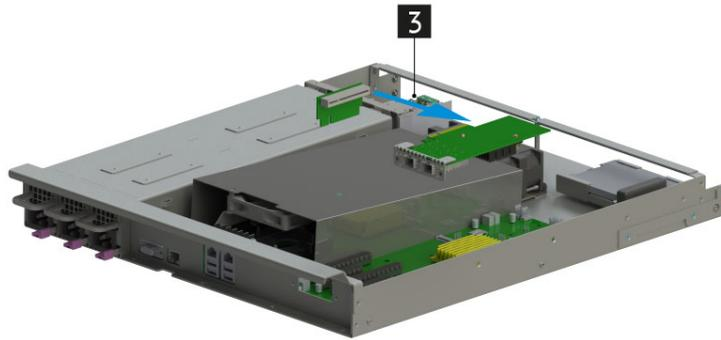
**Рис. 50. Снятие карты расширения**
