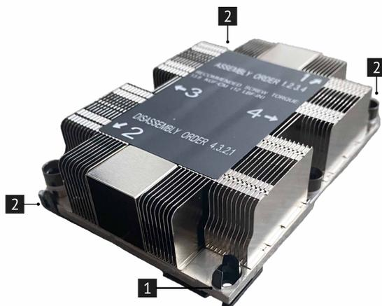
Рис. 37. Снятие процессора с 1U радиатора
