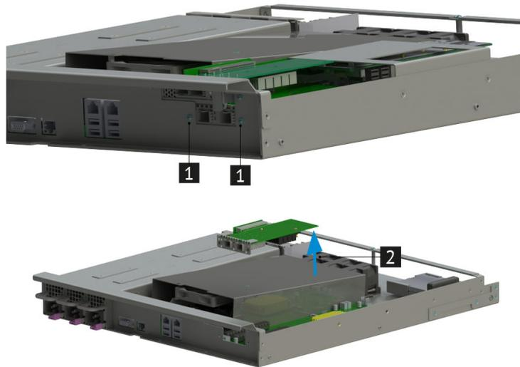
Рис. 48. Извлечение адаптера поворотного НИКА.469535.019 с картой расширения
