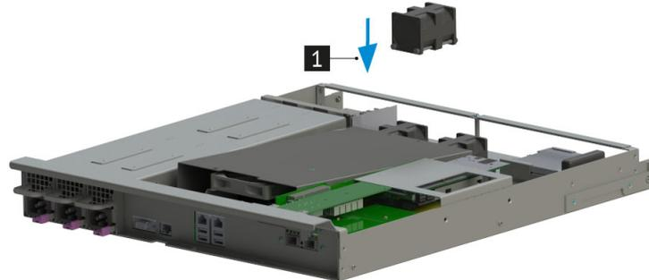
Рис. 27. Подключение вентилятора
