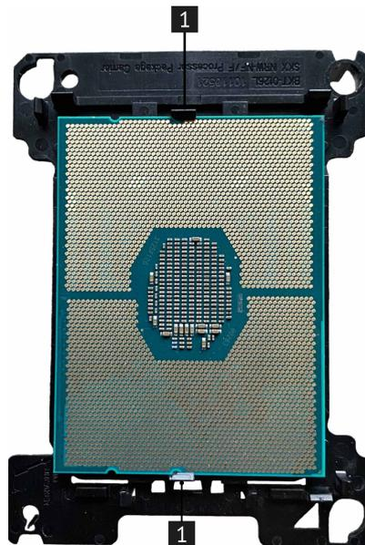
Рис. 38. Снятие процессора с радиатора
