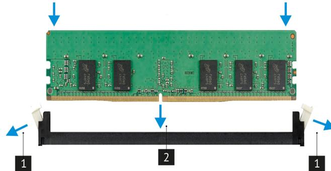
**Рис. 33. Установка модуля ОЗУ.**
