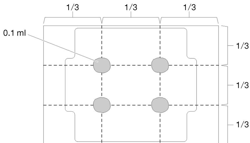
Рис. 39. Нанесение термопасты
