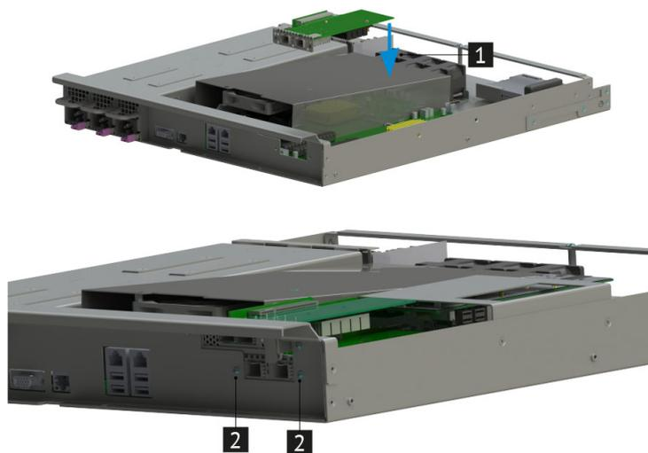
Рис. 49. Установка адаптера поворотного НИКА.469535.019 с картой расширения
