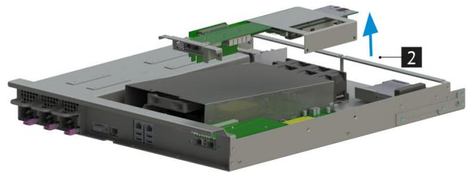
**Рис. 46. Извлечение адаптера поворотного НИКА.469535.122 с картами расширения**
