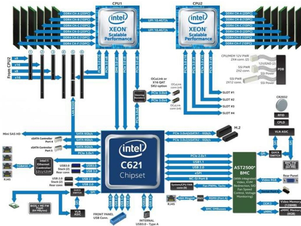
**Рис. 1. Структурная схема материнской платы Rikor® R-BD-SXRM-XS16.EA.V6.0**
