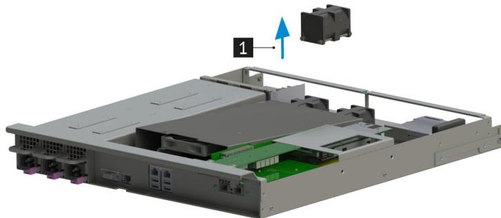
**Рис. 26. Извлечение вентилятора из поддона заднего НИКА.301414.011**
