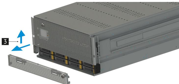
**Рис. 15. Снятие передней панели**
