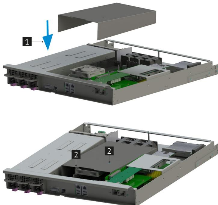
**Рис. 23. Установка воздушного кожуха**
