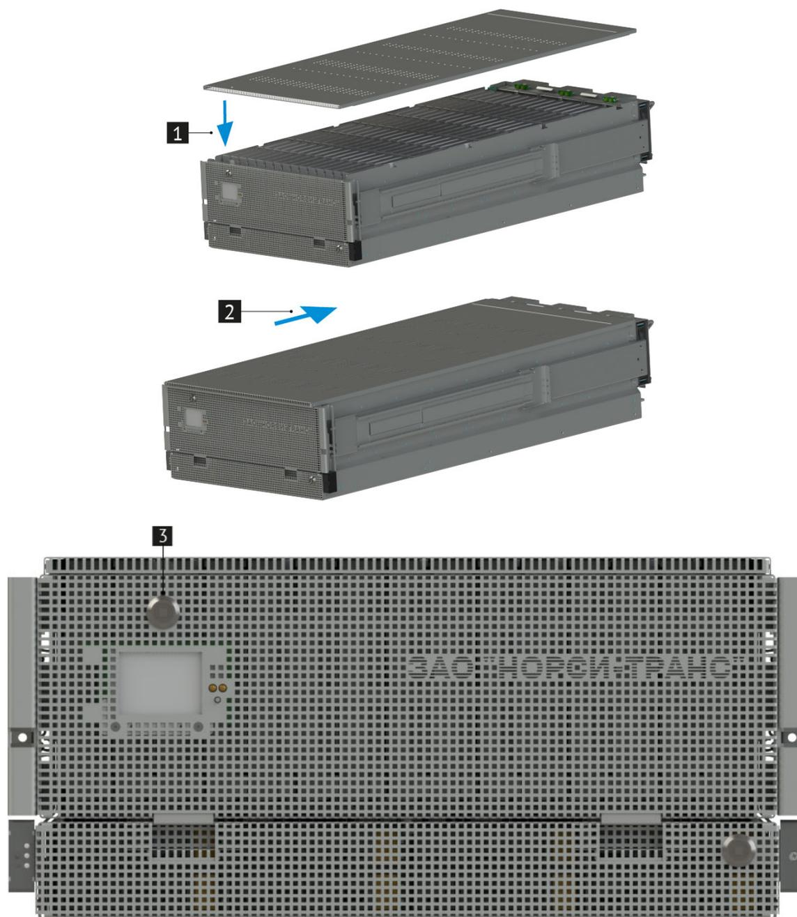
Рис. 19. Установка верхней крышки платформы
