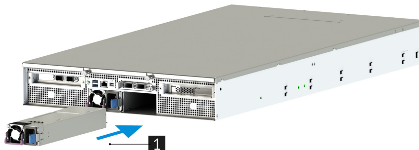
Рис. 61. Установка блока питания сервера
