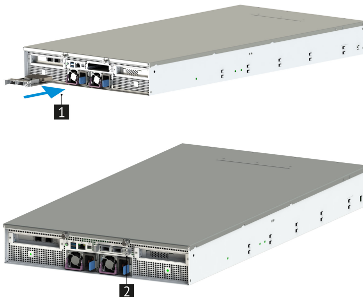
Рис. 56. Установка карты ОСР 3.0
