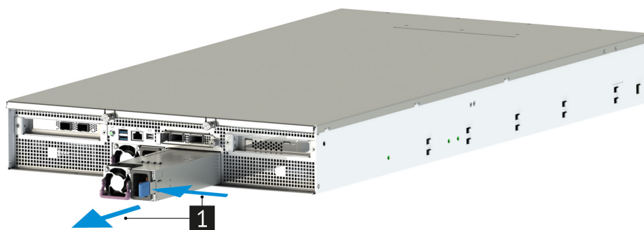
Рис. 58. Извлечение блока питания из сервера
