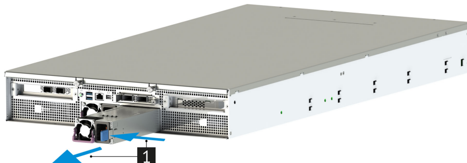
Рис. 60. Извлечение блока питания сервера
