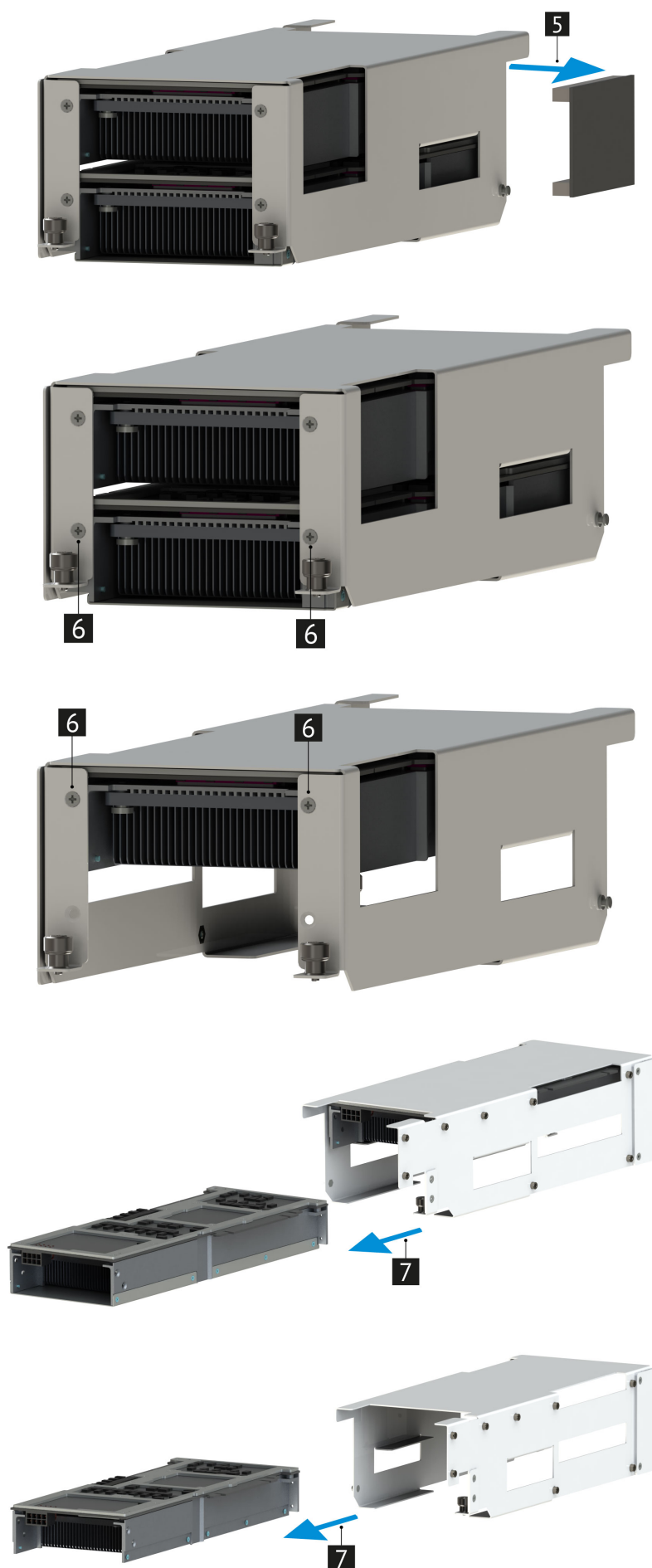
Рис. 51. Извлечение GPU-карт расширения
