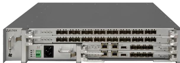
Мультисервисный узел доступа и агрегации MA5020 предназначен для построения сетей доступа по технологиям GPON/XGS-PON. Система позволяет строить масштабируемые отказоустойчивые сети «последней мили», отвечающие высоким требованиям безопасности, как в сельских, так и в городских населенных районах. Узел доступа осуществляет управление абонентскими устройствами, коммутацию трафика и соединение с транспортной сетью.
